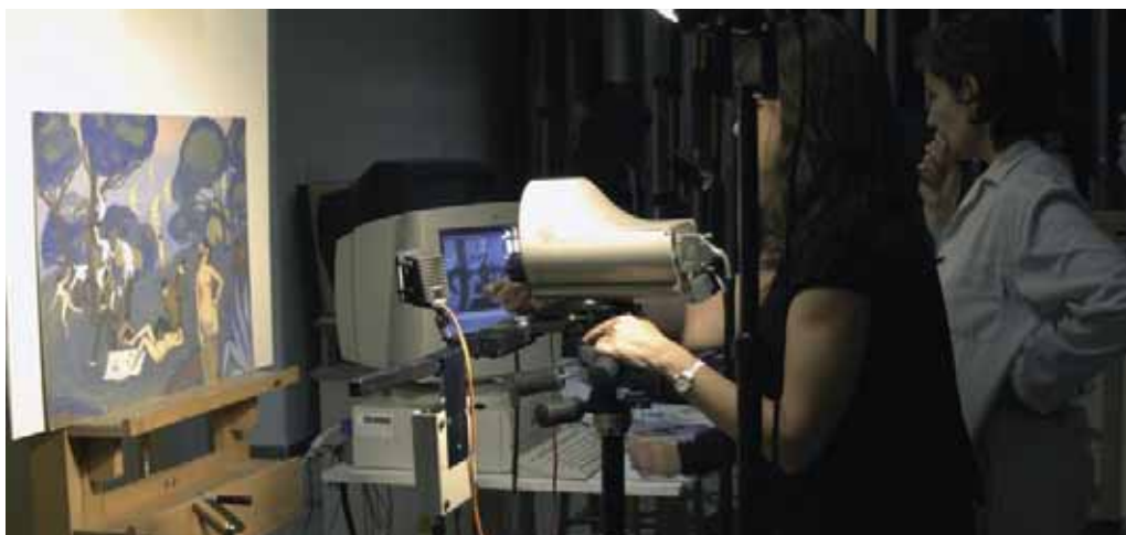
> Inspección con reflectografía de infrarrojos de un temple sobre cartón para ver el dibujo subyacente Inspecció amb reflectografia d'infraroigs d'un tremp sobre cartró per veure'n el dibuix subjacent
